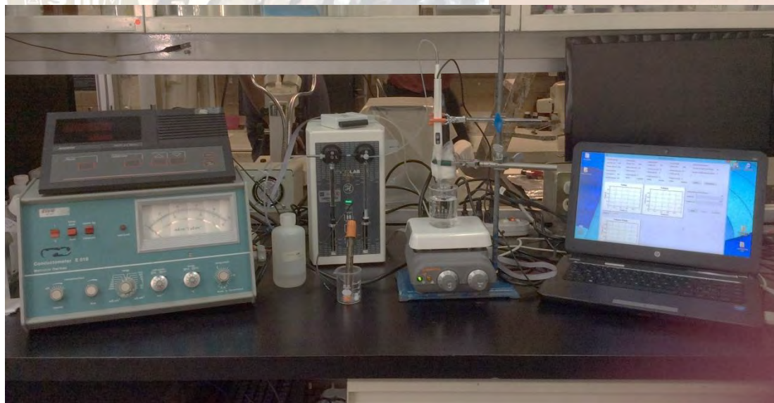
Figura 1 Sistema microtitulador compuesto de laptop, microdispensador, conductímetro, potenciómetro, interfase y agitador
