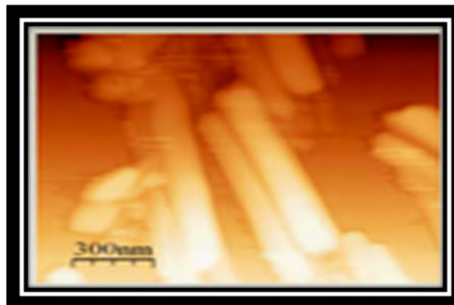
Figura 2. Imagen de la haloisita natural tomada con Microscopio de Fuerza Atómica de Amplitud Modulada (AM-AFM), acoplada a espectroscopia RAMAN, sistema N8 NEOS SENTERRA.
