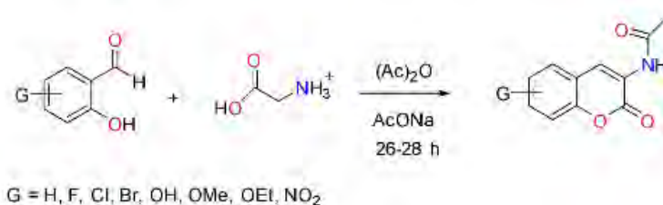
Esquema 1. Síntesis de acetamidocumarinas con diferentes sustituyentes
