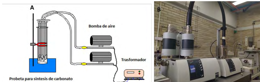
Figura 1A) Sistema diseñado para la síntesis de MgCO_3 atmosférico a partir del burbujeo de una solución saturada de Mg(OH)_2 . B) Sistema acoplado de análisis TGA-DSC-MS
