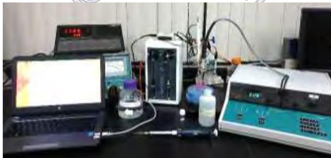
Figura 1 Sistema microtitulador compuesto de laptop, microdispensador, conductímetro, potenciómetro, interfase y agitador
