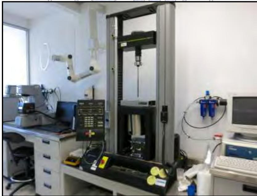
Figura 8.- Máquina Universal para pruebas físico mecánicas
