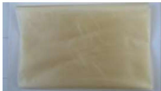
Figura 5.- Muestra de película soplada con nopal como bioplástico
