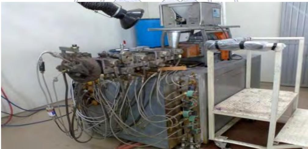
**Figura 3.- Equipo de extrusor mezclador doble tornillo**
