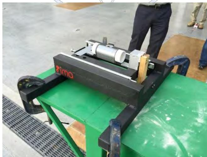
**Figura 7.** Un prototipo de motor montado en el banco de pruebas.
