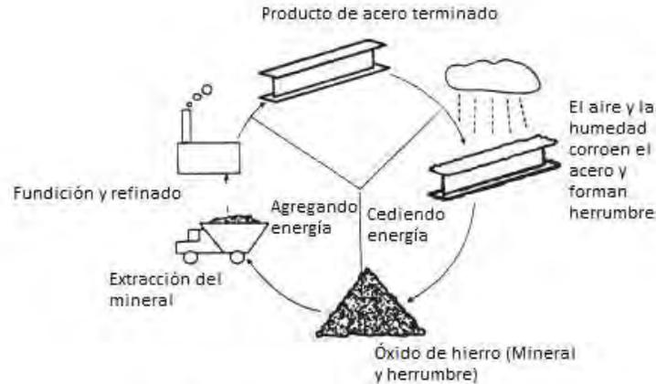
Fig. 1: El ciclo de corrosión del acero
