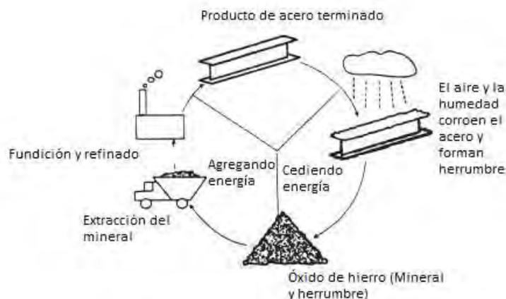
Fig. 1: El ciclo de corrosión del acero
