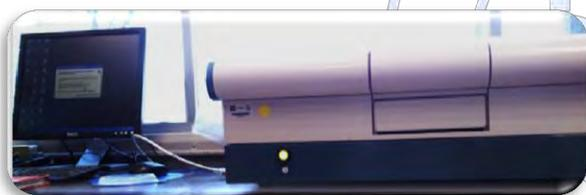
Figura 2. Espectrofotómetro Cintra 101.
