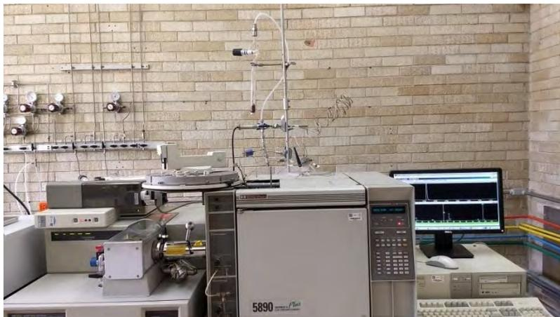
**Figura 3.** Sistema acoplado de análisis del laboratorio de Química de Plasmas y Estudios Planetarios del Instituto de Ciencias Nucleares de la UNAM.
