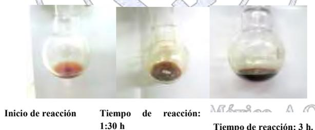
Figura 1. Monitoreo de la reducción completa de paladio
