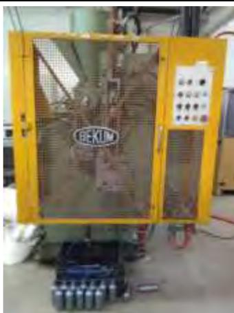
Figura 6.- Maquina sopladora de botellas
