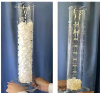
**Fig. 1.** Comparación de volumen de poliestireno expandido y densificado.
