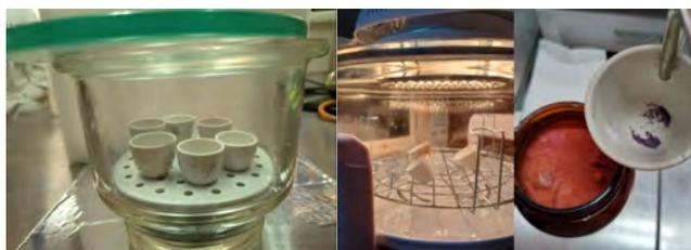
**Fig. 3.** Uso de desecador, cambio de color de cobalto, uso de infrarrojo.
