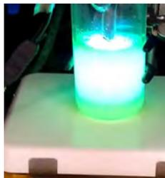
**Fig. 1.** Reacción de oxidación de naranja de metilo tipo Foto Fenton heterogénea como prueba catalítica.
