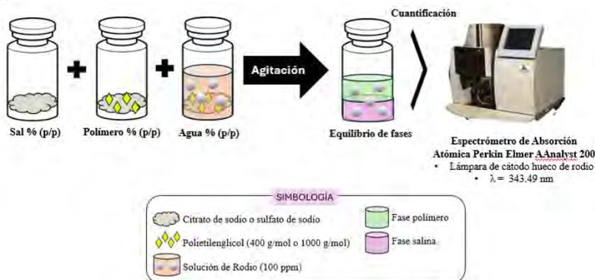
Fig. 1. Proceso de extracción de  $Rh^{3+}$  a 100 ppm sin pre-equilibrio de fases.
