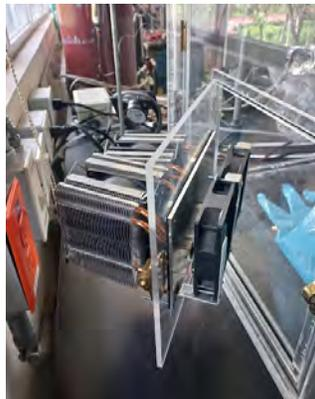
**Fig. 2.** Celda peltier.
