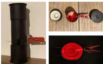
Figura 1. Prototipo que simula un espectrofotómetro para la enseñanza en el laboratorio de ciencias. Fuente: Elaboración propia basado en Ibañez-Cornejo (2020, comunicación personal).
