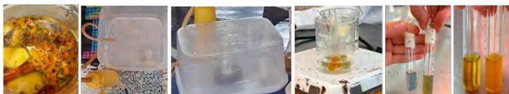
Figura 2. Diseño de experimento de fermentación a partir de elaborar tepache de 48 h. Se llevo a cabo la reacción de Jones, para valorar de manera cualitativa la presencia de etanol con el dispositivo construido. Fuente Elaboración propia.
