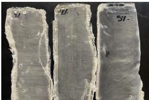
**Fig. 2.** Películas con miristato de isopropilo al 1, 2 y 5 %.
