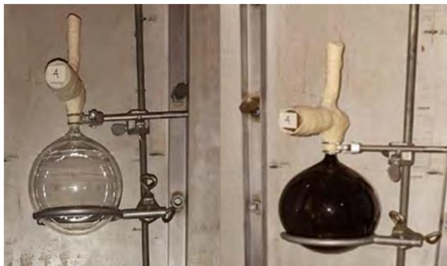
**Fig. 3.** Fotografía de los reactores que contenían la atmósfera simulada de Titán, lado izquierdo antes de ser irradiado, lado derecho después de ser sometida la atmósfera simulada a la radiación gamma, en el irradiador Gammabeam 651. Crédito Rodrigo Zamudio.
