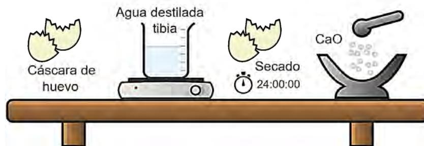
Fig. 1. Esquema de la obtención de óxido de calcio.
