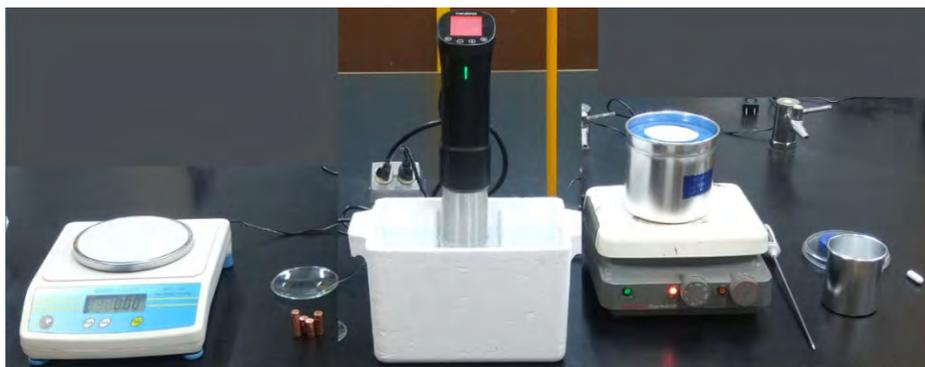
**Fig. 1.** Fotografía que muestra los reactivos, materiales y equipo para la medición del cambio de entropía del metal, el agua, el calorímetro y el universo termodinámico.
