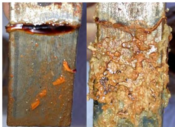
**Fig. 1.** Ejemplos de acción corrosiva del suelo. A la izquierda Muestra 4 (I=-5), a la derecha Muestra 18 (I=-14).
