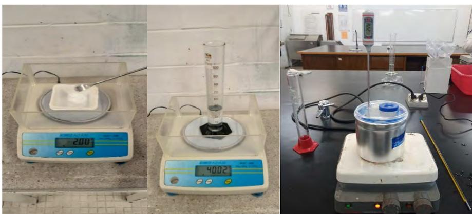
**Fig. 1.** Fotografías que muestran de izquierda a derecha: (a) medición de la masa de sal; (b) medición de la masa de agua; (c) montaje experimental para la medición del cambio de temperatura al interior del calorímetro, cuando se añade la masa agua a la masa de sal inorgánica.
