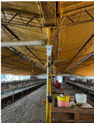
**Fig. 1.** Equipo Aeroqual instalado en área de confinamiento en jaulas comunes.
