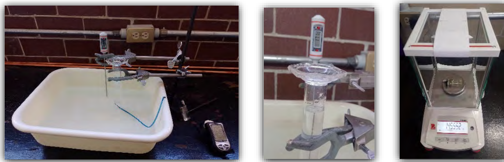
Fig. 1. Fotografías que muestran de izquierda a derecha: (a) medición de la masa del encendedor; (b) montaje experimental para la recolección del volumen de gas en una probeta invertida inundada con agua a temperatura ambiente y presión atmosférica; (c) medición del volumen de gas en la probeta invertida inundada.
