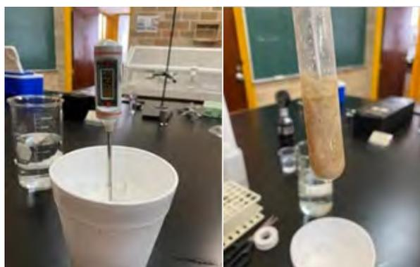
**Fig. 2.** Determinación de la temperatura de fusión del refresco de cola comercial.
