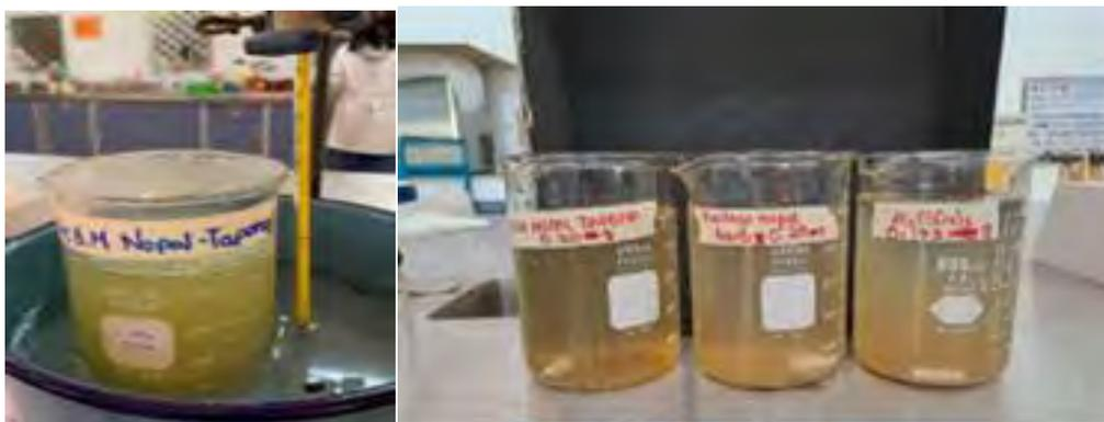
**Fig. 1.** De izquierda a derecha. Mucílago a baño María y muestras de agua tratada con mucílago de *Opuntia robusta*, mucílago de *Opuntia ficus-indica* y sulfato de aluminio tras ser sometidas a agitación, se notan las aguas con turbidez y sólidos suspendidos.
