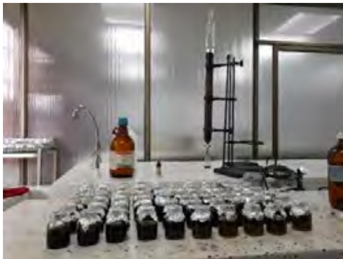
Figura 2: Fraccionamiento primario del extracto etanólico mediante cromatografía en columna.
