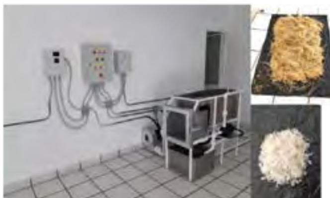
Figura 3. Prototipo final, plumas sucias y plumas después del proceso de lavado y desinfección.
