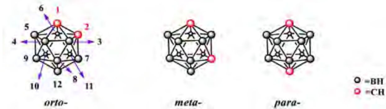
Figura 2. Representación gráfica y numeración de los isómeros del closo -C 2 B 10 H 12
