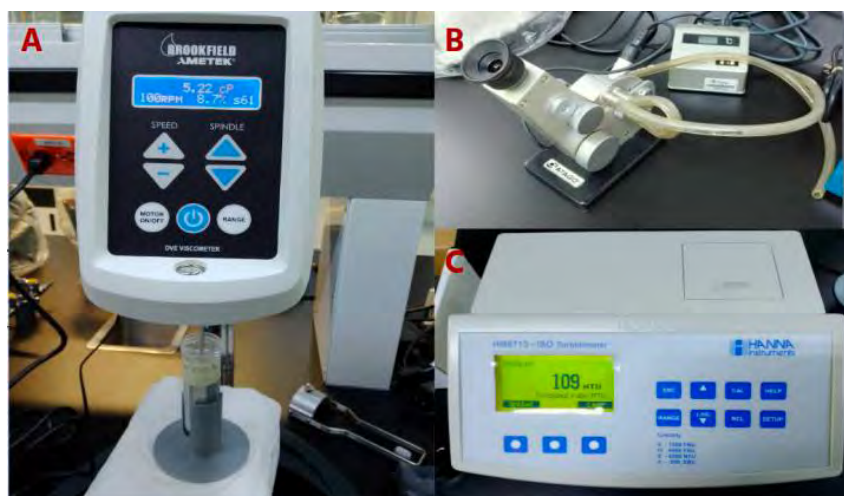
Fig. 2. (A) Medición de la viscosidad utilizando un viscosímetro. (B) Medición de grados brix utilizando un refractómetro. (C) Turbidímetro utilizado para la medición de la turbidez en NTU.
