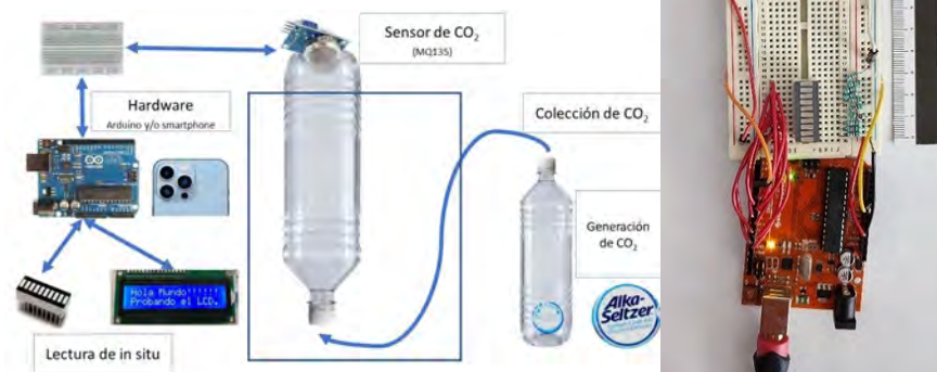
Fig. 2. diagrama de montaje para la realización del experimento para determinación de \text{CO}_2 , con este método pueden abordarse los temas de cinética y estequiometría, entre otros que puedan resultar interesantes a profesores y alumnos.
