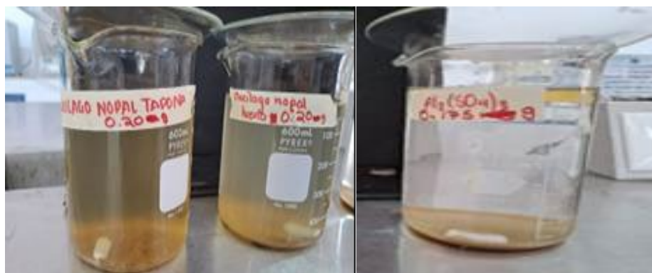
Fig. 2. De izquierda a derecha. Muestras de agua tratada con mucílago de Opuntia robusta (vaso de precipitado a la izquierda) y con mucílago de Opuntia ficus-indica (vaso de precipitado a la derecha) tras reposar 30 minutos luego de la agitación, se nota realmente una disminución en la presencia de sólidos suspendidos y por lo tanto mayor transparencia; Muestra de agua tratada con sulfato de aluminio tras reposar 30 minutos luego de la agitación, igualmente muestra mayor nitidez.
