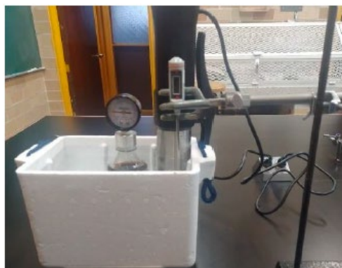
Fig. 1. Fotografía que muestra el montaje experimental para la medición de la presión manométrica y de temperatura del refresco de cola comercial sumergido en el baño de agua termostatzado dentro de la hielera de unicef.
