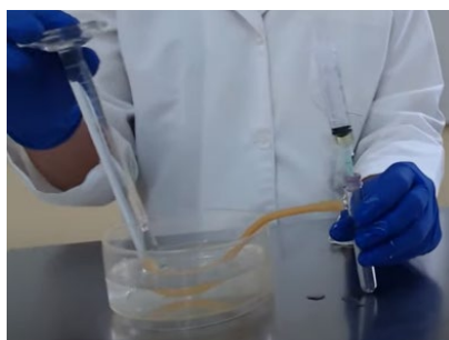
Fig. 1. Sistema para recolectar el gas hidrógeno obtenido en la reacción de desplazamiento del zinc con ácido clorhídrico.
