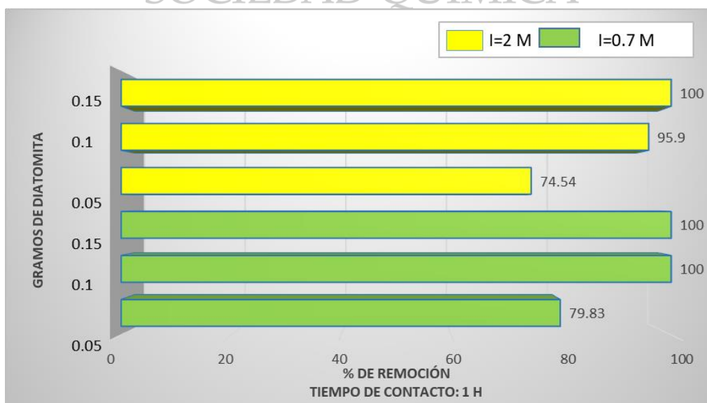
Figura 2. Porcentaje de remoción de diatomita a un tiempo de contacto de 1 H.
