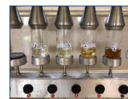
Ilustración 1. Fibra Cruda: Digestión ácida de la muestra con H_2SO_4 1.25%.
