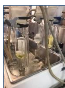
Ilustración 3. Lípidos: Obtención de grasa de la muestra mediante sistema Soxhlet y éter etílico como solvente.
