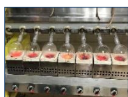
Ilustración 2. proteína: Digestión ácida de la muestra con H_2SO_4 0.1111 N
